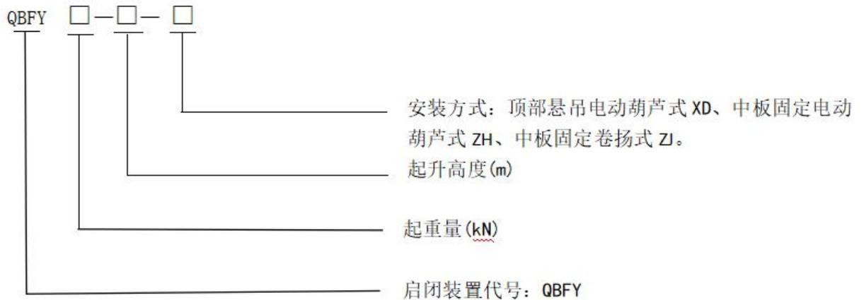
标记示例：起重量80+80 kN，起升高度6.9 m，顶部悬吊式的启闭装置，标记为QBFY16×10-6.9-XD。
