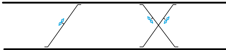
图 C. 3 道岔区段计轴布置示意图
